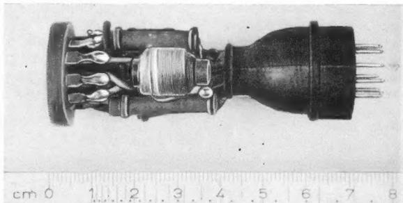
Bild 7. Fertiger Adapter ohne aufgesetzte Röhre ECH 81; Höhe ca. 75 mm
